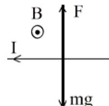
دو نوار بسیار نازک قابل انعطاف را به طور موازی به هم بسته و دو سر مجموعه را مطابق شکل به منبع تغذیه وصل می‌کنیم با بستن کلید  $k$  دو جریان همسو در نوارها برقرار می‌شود. مشاهده می‌شود که سیم‌ها جذب هم می‌شوند یعنی به آن‌ها نیرو وارد می‌شود زیرا هر نوار در میدان مغناطیسی جریان عبوری از نوار دیگر قرار دارد.
